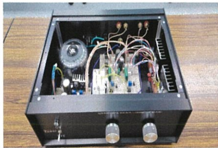
▲ オーディオ用アンプ試作機 東京大学製有機トランジスタによる 世界初の実験機
